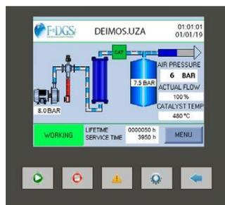
由彩色触摸屏控制，实时显示工作过程、系统状态，并可远程接入进行诊断控制。
