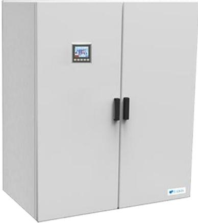
CryoGen 是一款独立的可持续生产液氮的纯化系统。利用可靠的冷头“Cryo-refrigerator”设计和氮气压缩机,将 PSA 技术产生的氮气冷却至 77K (-196°C)而产生液氮。系统的控制采用最新的 HMI 触屏技术,实时显示系统的工作进程、PSA 制氮,杜瓦罐的液面深度等状态。只需按一下按钮,即可全自动运行。
