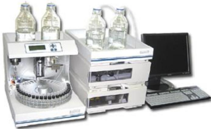
高效液相色谱仪：Agilent 1100，配置 G1354A 四元梯度泵及 G1314A 紫外检测器。
