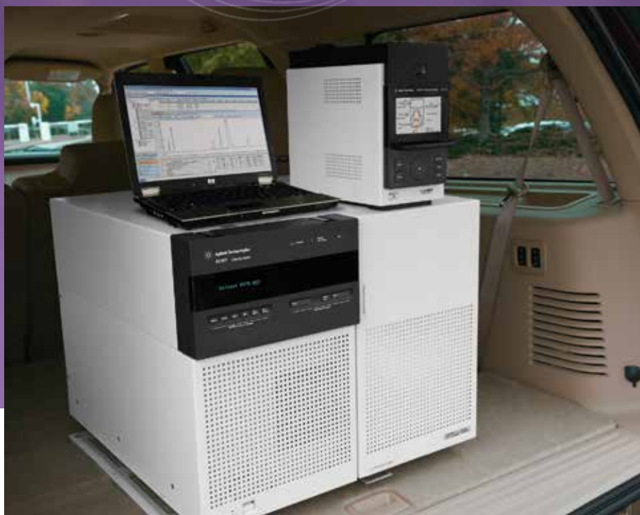
Agilent 7667A 微型热脱附仪与安捷伦的便携式 5975T GC/MS 和 490 微型气相色谱仪完全兼容——适用于各种军事、环境、职业安全和法医学应用。
